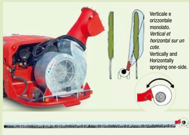
CANNONE SIMMETRICO 65-S Dielectric - A lunga gittata (40 m) • Adatto a trattare qualsiasi tipo di Coltura Erbacea e Pianta Altissime • Dotati di Bocca "Tratta Vicino" per il trattamento soffice alle superfici vegetative vicine. La Bocca "Tratta Vicino" è ad angolo regolabile ed a riposizionamento automatico, a Dx e a Sx.
