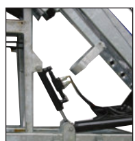
Correttore idraulico (Regolatore di inclinazione idraulico) Hydraulic Adjusting Balancing Device
