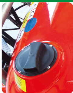
✓ Cuve de rinçage
