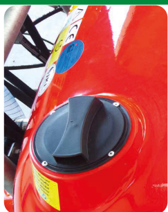
✓ Cuve de rinçage
