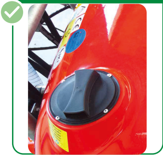
Cuve de rinçage
