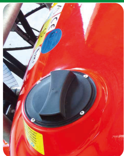
✓ Cuve de rinçage
