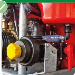
Filtre d'aspiration avec « Pulvériser-rincer »
