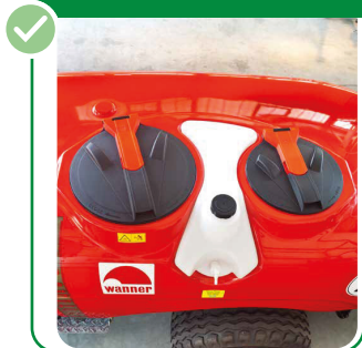
2 orifices de remplissage avec tamis de cuve
