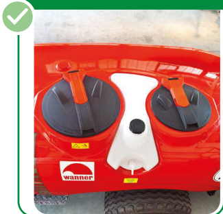
2 orifices de remplissage avec tamis de cuve
